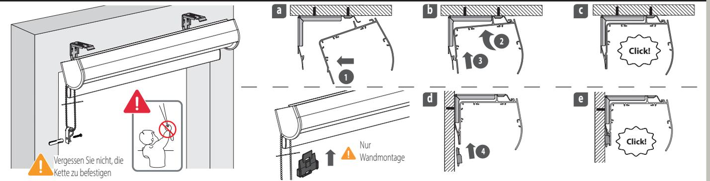
6b. EINBAU DER KASSETTE FÜR EINEN MOTORISIERTEN BEHANG
