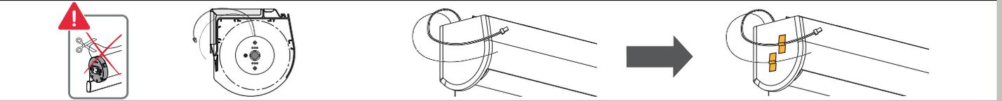
5. SICHERHEITSHALTERUNG ENTFERNEN
